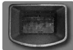
Cajón que necesita limpieza con los orificios obstruidos por las cenizas
