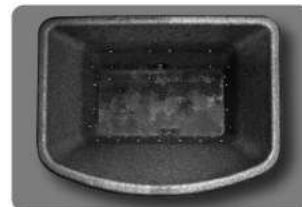
Brændskål som har brug for rengøring med hullerne tilstoppet af aske
