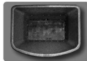
Cestello che necessita di pulizia con i fori otturati dalla cenere
